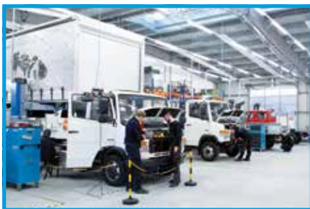
Elektro-Umbauten in der Fertigungshalle
